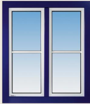
Die Außenseite des Holz-Alufensters ist durch beschichtetes oder eloxiertes Aluminium witterungsbeständig. Zwei Stockdichtungen und eine Überslags-Flügeldichtung sowie das Wärmeschutz-Isolierglas garantieren eine hohe Schall- und Wärmedämmung.
